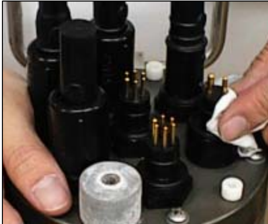
バルクヘッドコネクタの表面を清掃します
