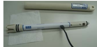
通信ケーブルの接続
