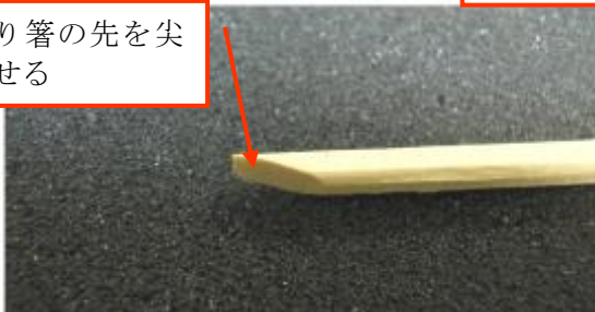
図7：タイゴンチューブ外し用工具を割り箸で作成
